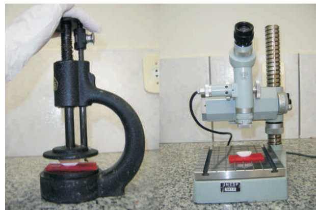
FIGURA 4 – a) Espécime sob ação do paralelômetro; b) Mensuração do ângulo de contato em microscópio Carl Zeiss
